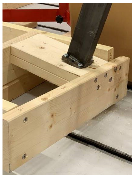
Figur 66 Test 42, ved bruddlast på 3,3 kN
