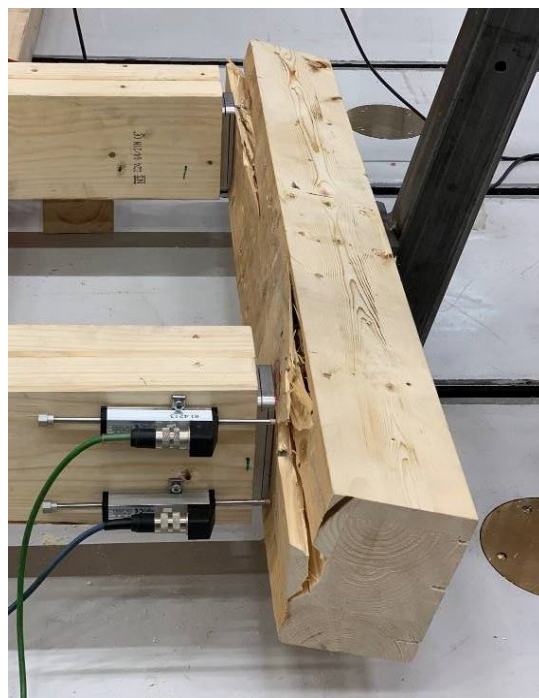
Figur 60 Test 39 ved bruddlast
