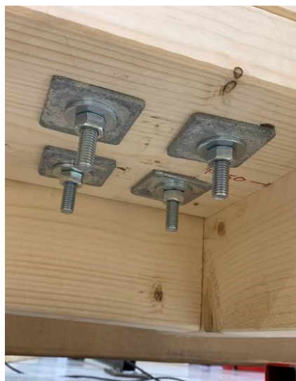
Figur 64 Test 42, med blant annet gjennomgående skruer og store firkantskiver
