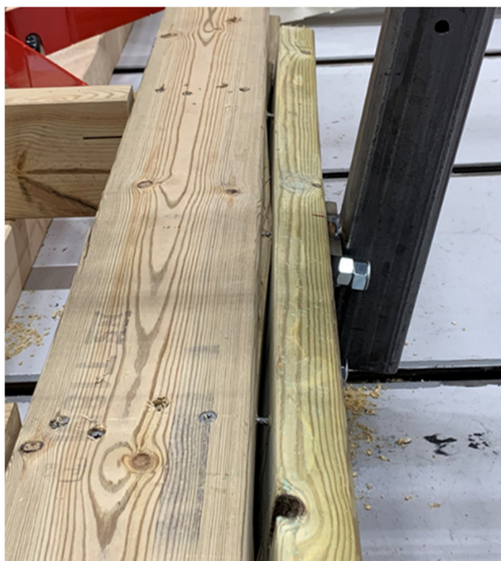
Figur 35 Topplanke sprekker ved bruddlast.
