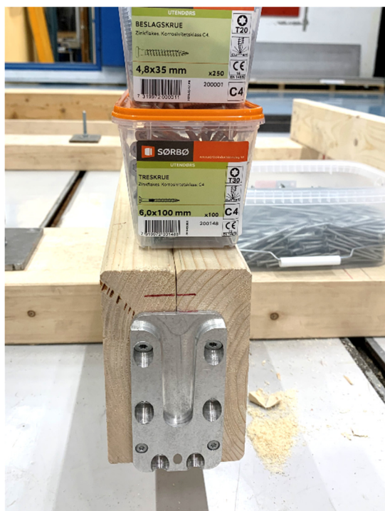
Figur 57 Prøveoppstilling Q. Beslagsdel montert i endevend
