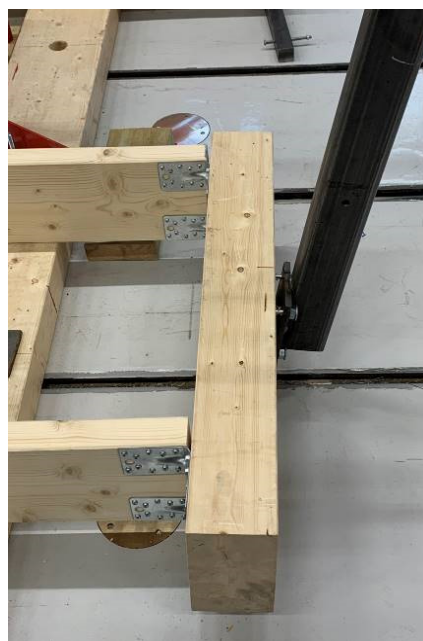
Figur 41 Test 18 ved bruddlast
