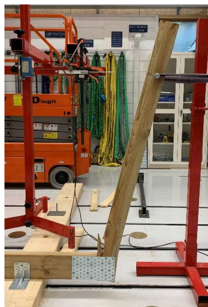
Figur 62 Test 40 ved bruddlast
