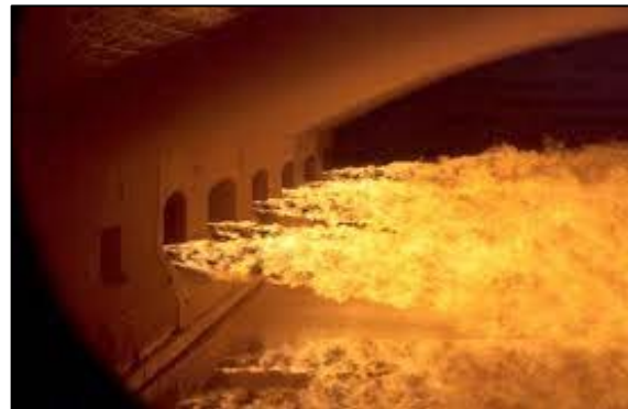
Brennende gass i smelteovnen bringer temperaturen til 1550 °C
