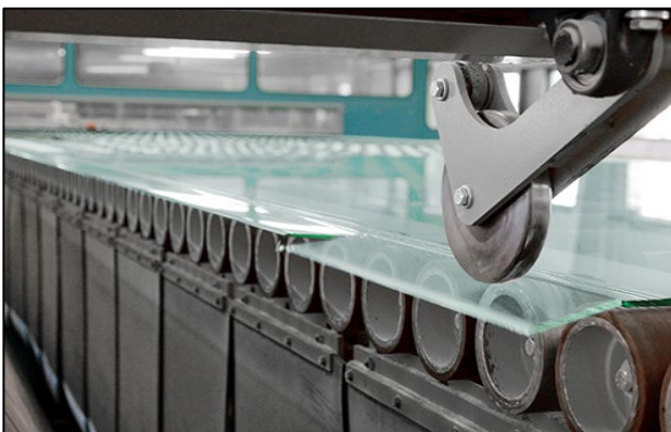
Sporene etter topprullene skjæres vekk
