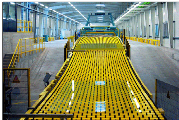
Glassplatene er klare til å løftes av produksjonslinjen
